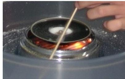
*Al estar pintado de negro, el recipiente anular comienza a calentarse. Las paredes inclinadas hacia dentro impiden que el azúcar sólido se desplace hacia el exterior. Cuando se alcanza la temperatura de fusión de la sacarosa, el fundido sube por las paredes y sale del recipiente en forma de finos hilos que se solidifican en cuanto salen del recipiente caliente.*
